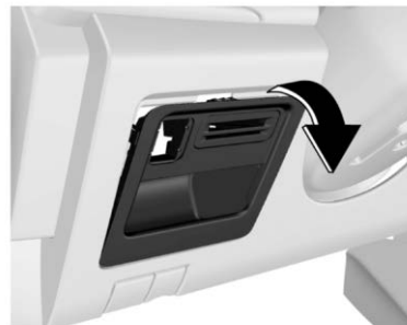
Caja de fusibles interior
